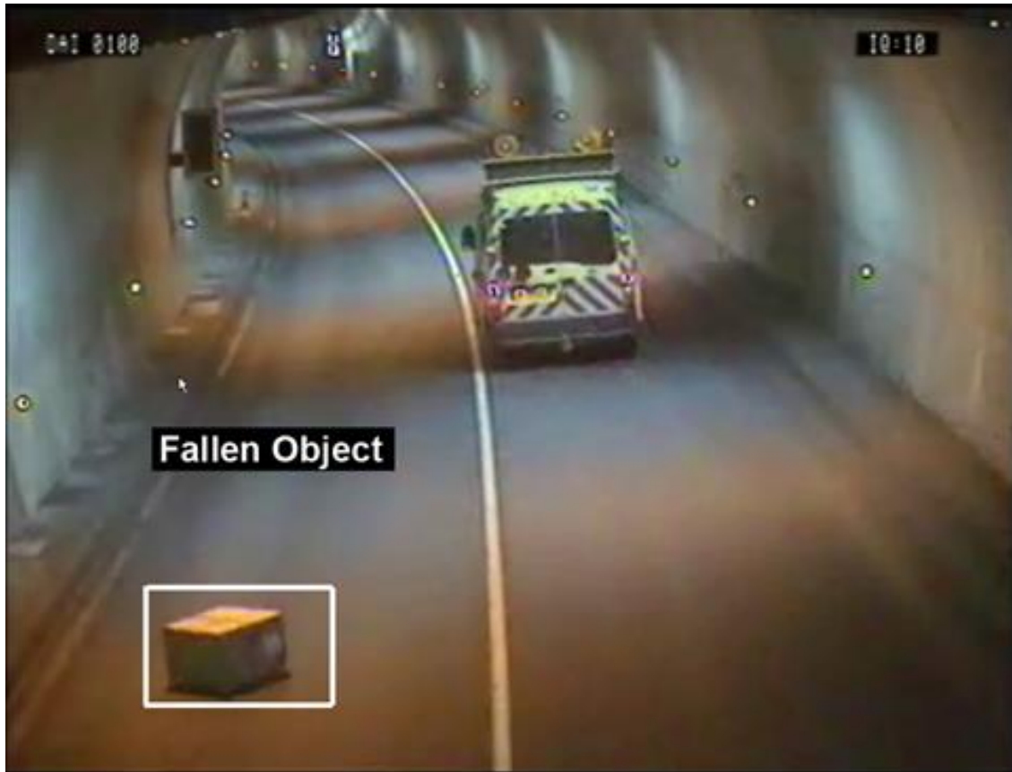
Figur 15: Teledyne-Flir AID systemet har detektert en kasse i Operatunnelen i Oslo
